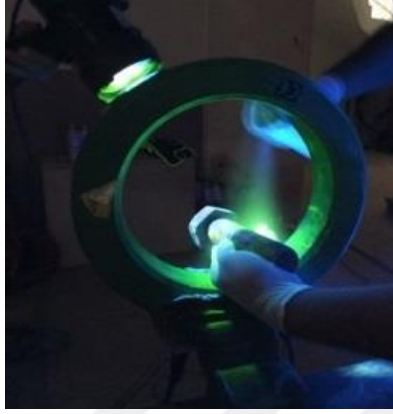
Şekil 3.3 Malzemenin manyetize edilmesi
